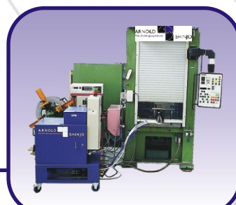
Stansmoer-systeem direct in het gereedschap
