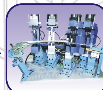
C-beugel installatie in de cascobouw
