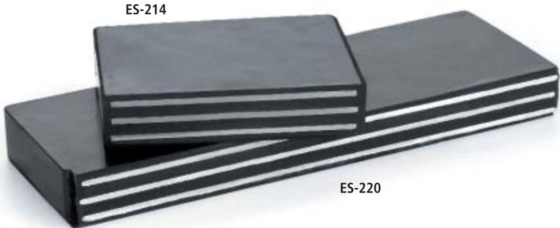
Die schichtweise Anordnung von schallharten (z.B. Metall) und schallweichen (z.B. Gummi) Materialien bewirkt eine zusätzliche Reflexionsdämmung (siehe Seite 30). Mit geringer Einfederung erreicht das Schichtlager den höchstmöglichen Dämmgrad bei kleinstmöglicher Nachgiebigkeit. Belastungen von 300 bis 800 N/cm<sup>2</sup>.
