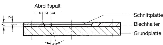
Schematische Darstellung des Schneidvorgangs
