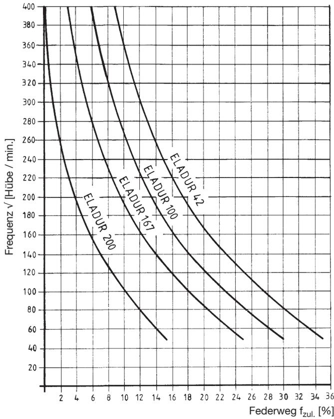
ELADUR-Federn können als Einzelfeder, Federkissen (mehrere Federn in Parallelanordnung) oder als Federsäule (mehrere Federn hintereinander) eingesetzt werden. Der Federwerkstoff ist inkompressibel, deshalb weitet sich die ELADUR-Feder bei Druckbelastung aus. Der Platzbedarf ist untenstehender Tabelle zu entnehmen.
