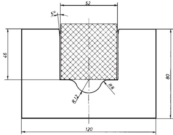
Vorgeformtes Kissen für das Biegen von U-Profilen
