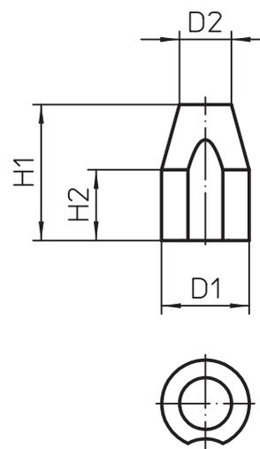
Eladur-Abdrücker werden in Stanzwerken zum Abstoßen der Stanzbutzen- bzw. Stanzteile eingesetzt. Der Einbau erfolgt durch Einpressen in entsprechende Sackbohrungen.
